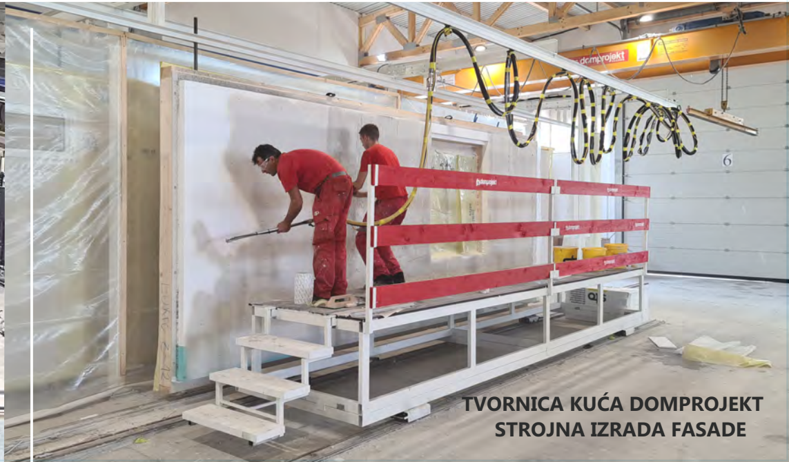
TVORNICA KUĆA DOMPROJEKT PROIZVODNJA ZIDNIH ELEMENATA
